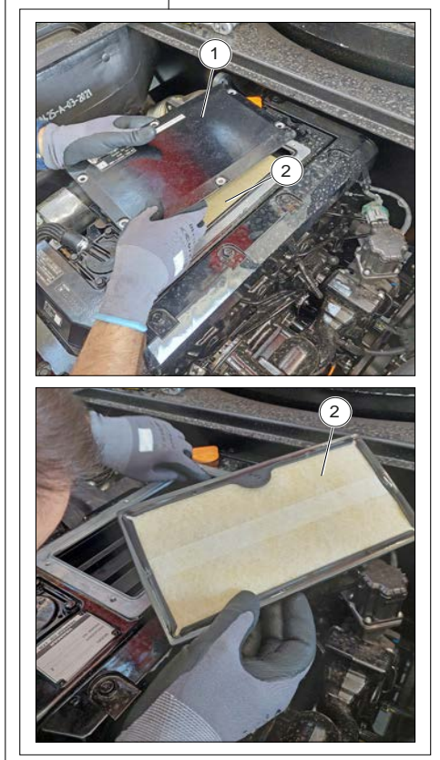
Afbeelding 209: Het carterfilter van de motorontluchter vervangen
